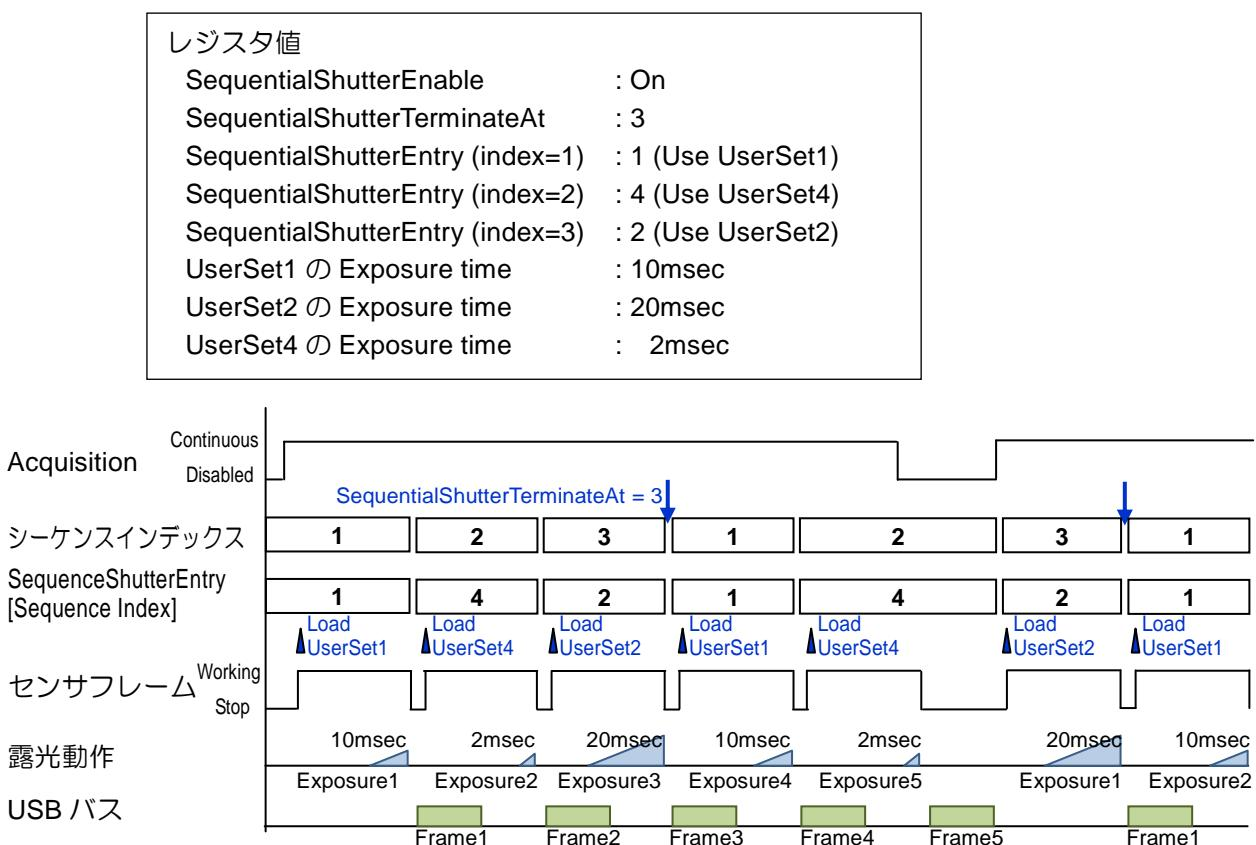
シーケンスインデックスは1から加算されていきますが、Aquisitionを停止状態にしても1にクリアされません。Aquisition停止中にSequenceShutterEnableレジスタを一旦ディスorghるにしてから再度イネーブルにすることによりシーケンスインデックスが1にクリアされます。
